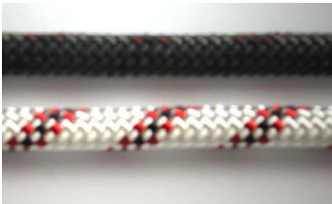
Abb.3: Schwarzfärbung des Seiles durch Bremsstaub
