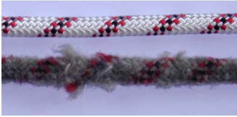
Abb.2: starker Seilabrieb, Abnutzung mit Seilverdickung
