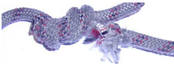
Abb. 1.: Faserbrüche am Knoten
