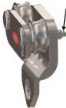
Bild B 7 - Verriegelungsmechanismus OK – grüner Ring am Entriegelungsknopf sichtbar, wenn Läufer geschlossen.
