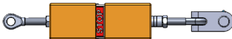
Bild B 1b - Spanner mit ausgelöstem Absturzindikator
