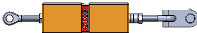
Bild B 1b - Spanner met geactiveerde valindicator
