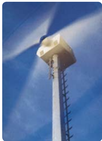
Aerogenerador con escalera en acero galvanizado
